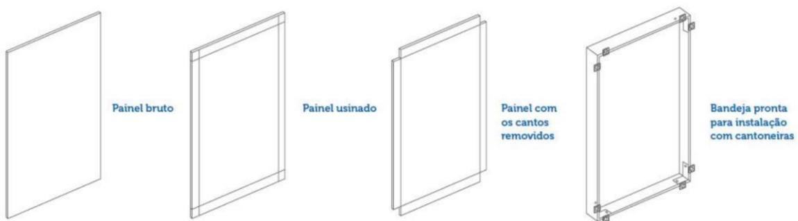
Figura 9: Diretrizes de montagem especial – Placa ACM
