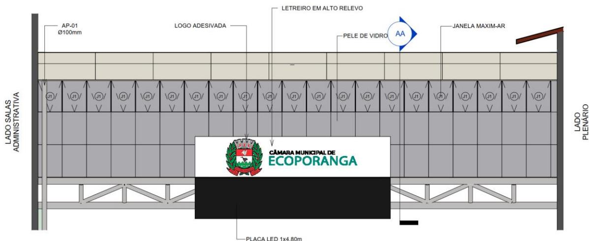
Figura 21: Vista da passarela – Localização da Pele de Vidro e Janela Maxim-ar
